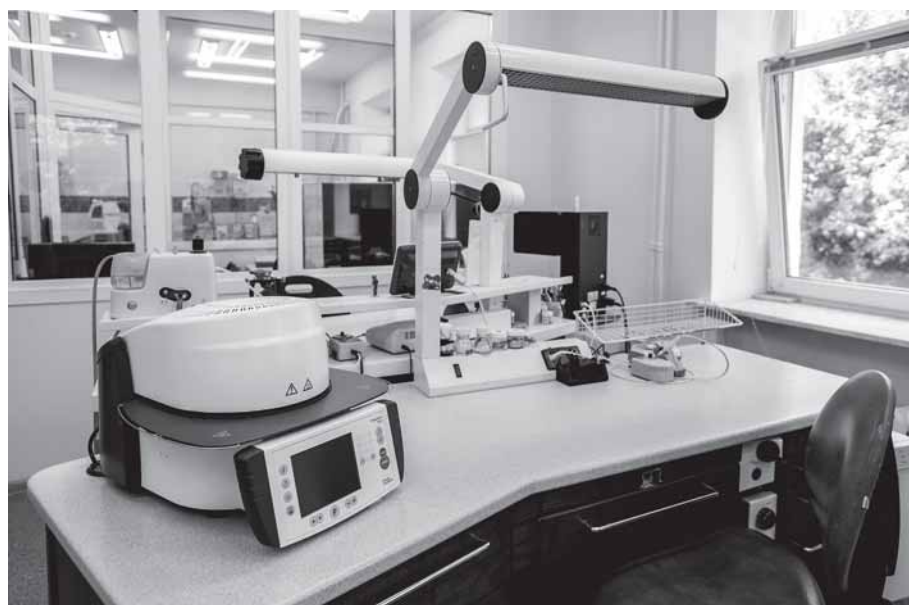
Печь Vita Vacumat 6000M для изготовления протезов из безметалловой керамики
