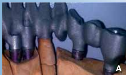
Рис. 2. Экспериментальные модели интерфейса «имплантат–абатмент» для множественных опор: А – после изготовления методом литья и искроэрозионным способом; Б – после припасовки ручным способом соединительного узла фрезами на имплантатах. Неточное прилегание интерфейса показано стрелкой
