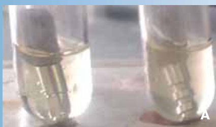
Рис. 3. Сравнительная экспериментально-микробиологическая оценка герметичности соединения одиночных имплантатов с абатментом. 1 группа – интерфейс «имплантат-абатмент» только после литья и пескоструйной обработки без полировки абатмента (а), 2 группа – интерфейс «имплантат-абатмент» после литья пескоструйной обработки и полировки абатмента но без искраэрозионной обработки соединительного узла (б), 3 группа – интерфейс «имплантат-абатмент» после литья и полировки абатмента с искраэрозионной обработкой соединительного узла (в). Приведены фотографии после 24 часов инкубации в питательной среде
