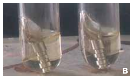
Рис. 3. Сравнительная экспериментально-микробиологическая оценка герметичности соединения одиночных имплантатов с абатментом. 1 группа – интерфейс «имплантат-абатмент» только после литья и пескоструйной обработки без полировки абатмента (а), 2 группа – интерфейс «имплантат-абатмент» после литья пескоструйной обработки и полировки абатмента но без искраэрозионной обработки соединительного узла (б), 3 группа – интерфейс «имплантат-абатмент» после литья и полировки абатмента с искраэрозионной обработкой соединительного узла (в). Приведены фотографии после 24 часов инкубации в питательной среде
